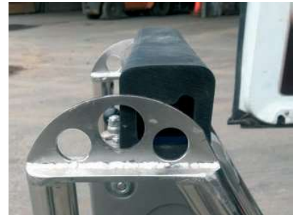
Erdnagelbefestigung für DD300 auf Siebdruckplatte
